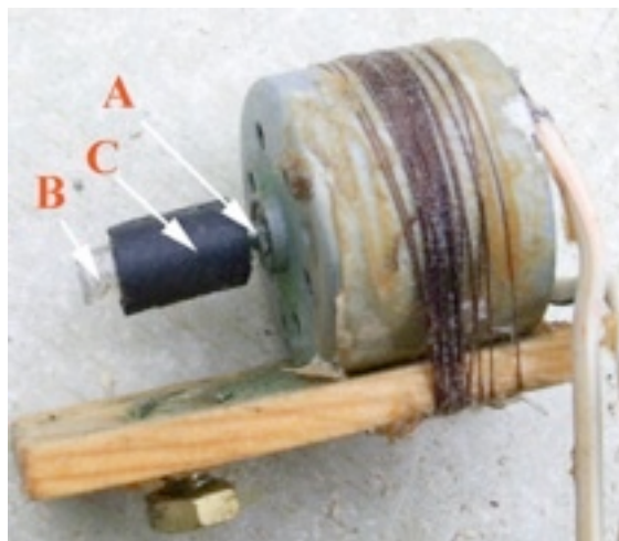
A - Eixo do gerador B - Pedaço de tubo plástico (de uma caneta) C - Tubo de borracha cortado da ligação de uma bomba de bicicleta
